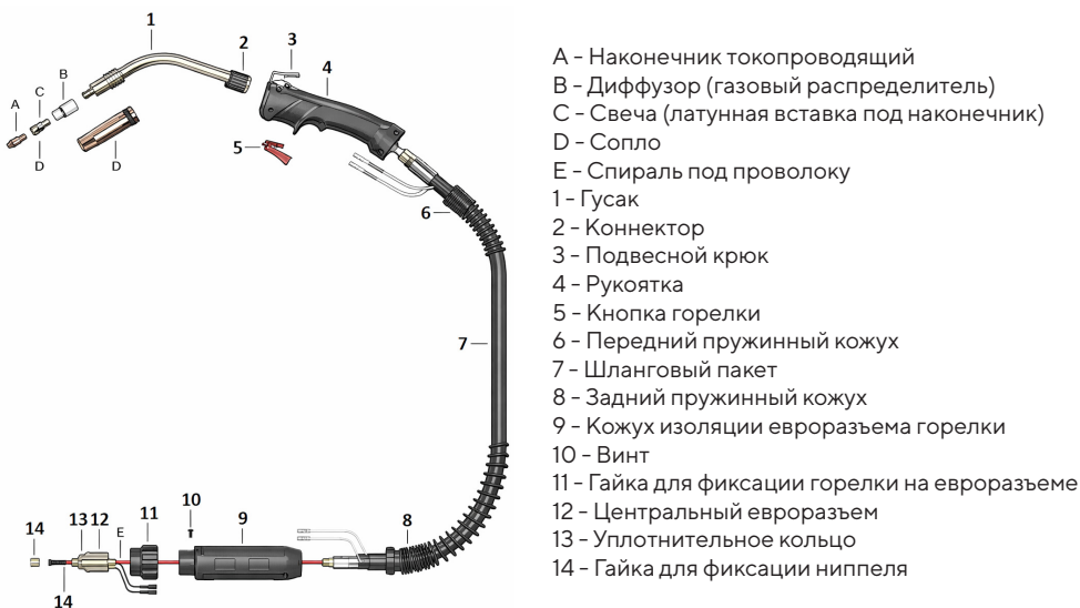
Рисунок 2 – Составные части горелки для MIG сварки
